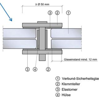
Abbildung 4: Querschnitt Tellerhalter
